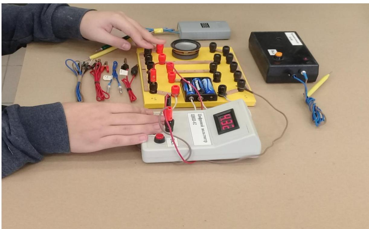
Разработан новый цифровой вольтметр измерительный со звуковым и световым выводом индикации напряжения от 0 до 99 В. со встроенным синтезатором речи фирмы «Motorolla» для проведения практических занятий на уроках физики и технологии для слепых и слабовидящих детей.
